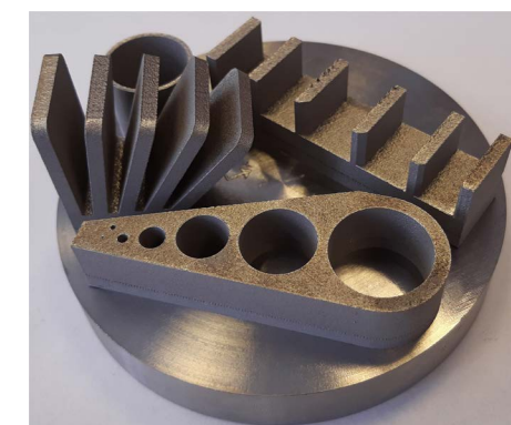
6.3.3.1. ÁBRA Lézeres, fémporágyas additív gyártás (know-how).
